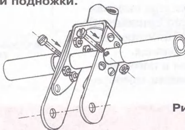
Рис. 9. Установка рулевой подножки.
